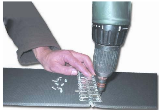
Rys. 4: Wkrecać śruby pionowo
