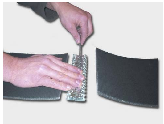
Rys. 2: Przeciągnąć linkę przez połączenie
